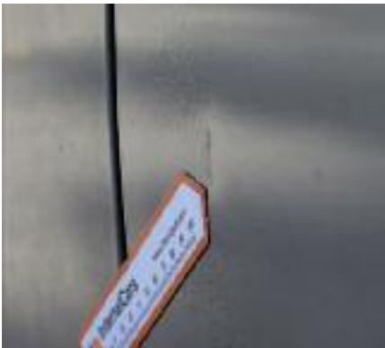
Buckla, repor eller annan skada där lack är skadad ner till grundlacken eller till underliggande plåt/plastskikt. Gäller oavsett storlek på bucklan.
